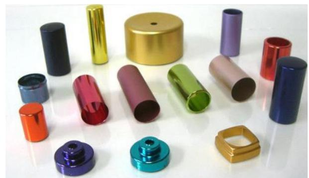
L'aluminium que l'on utilise le plus en mécanique est le EN AW 2017 qui comporte 4% de cuivre et un pourcentage plus faible de d'autres éléments d'addition en plus de l'aluminium. Très bonne conductibilité thermique. Bonne usinabilité. Résistance à la corrosion à l'air acceptable. Anodisable.
